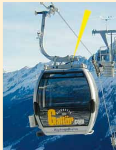
Гидравлические демпферы повышают комфорт при поездках на фуникулере
