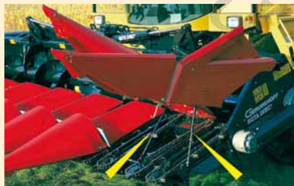
Промышленные газовые пружины поддерживают тяжелые крышки капотов
